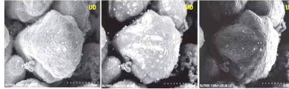
Yüzey mikro-yapısal bilgileri (UD), yüzey kaplaması (MD) ve genel topografik bilgiler (LD) için eş zamanlı görüntü edinimi. Yapılan Analizler
